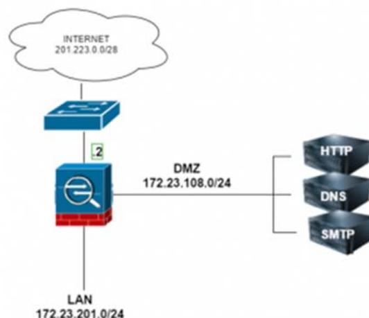
En la figura se aprecia que la DMZ es una subred independiente, separada de la LAN y de Internet, con ello se puede configurar el firewall para crear reglas específicas de seguridad y NAT que permitan el tráfico proveniente de Internet solamente hacia esa zona. El NAT estático estaría asociado entre las IP públicas y las IP asignadas a cada servidor en la DMZ. Así, si un hacker vulnera la seguridad de uno de los servidores, este no tendría acceso a la red LAN corporativa.
