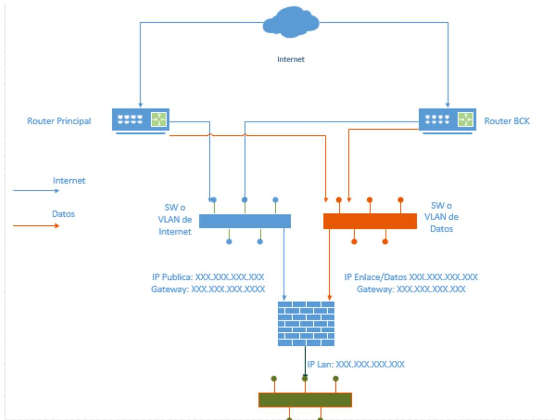
Adicionalmente se configura un enlace de datos por medio de una VPN creada por el ISP para la comunicación con otra sucursal o campus. Se agrega un switch entre los router y el firewall, en este switch se han creado VLANs para separar ambas redes la de internet y la de datos.
