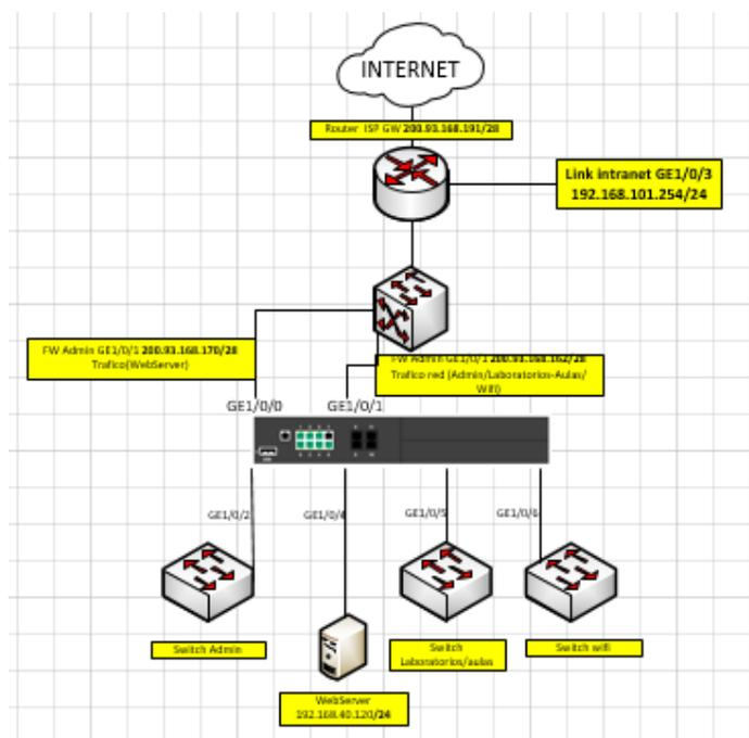
La tercera parte se utiliza un tercer Appliance NGFW – UTM. Este se conecta a la red de servicios (Network – LAN Core – Services) y a la red de aplicaciones (Network – LAN Application).
