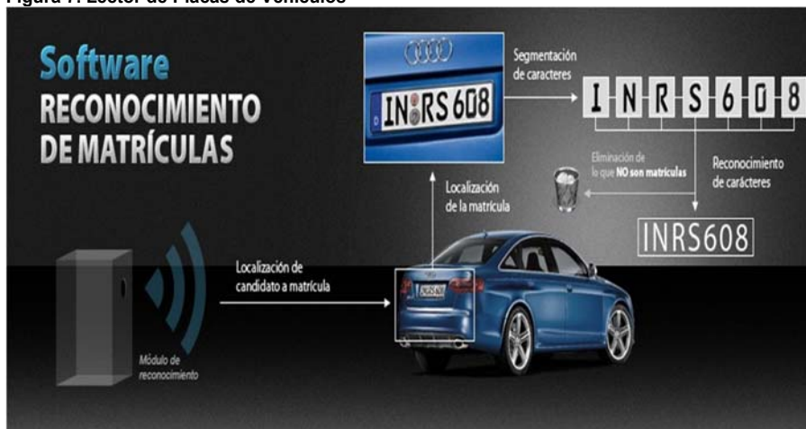
Figura 7. Lector de Placas de Vehículos
